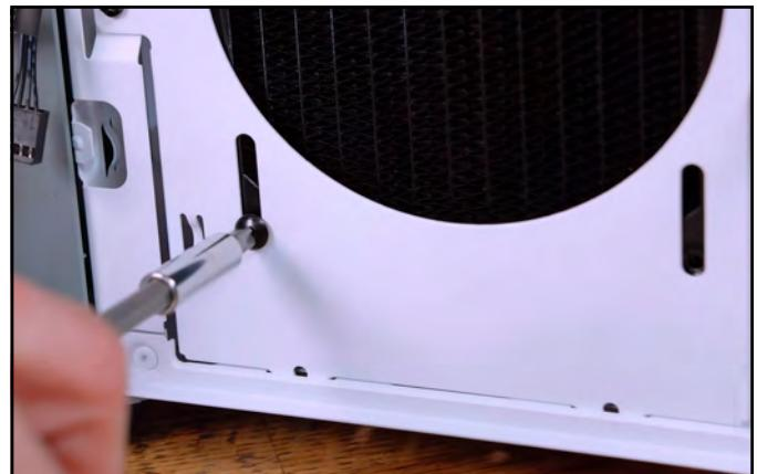
**B:** Sie werden benutzt für die Montage der Standardventilatoren in der Dicke von 25mm an den Kühler, direkt oder durch das Chassis.
