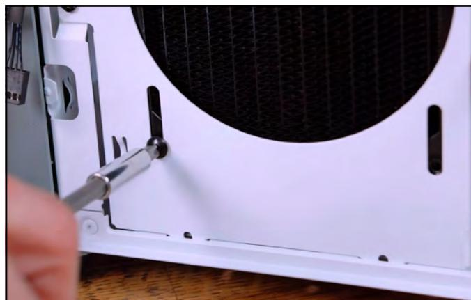
**B:** Utilisé lors de la fixation de ventilateurs standards de 25mm d'épaisseur, soit directement, soit à travers un châssis.
