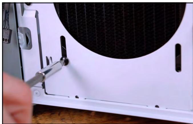
**B:** Используется, когда на радиатор устанавливаются стандартные вентиляторы толщиной 25мм - напрямую или с использованием шасси.
