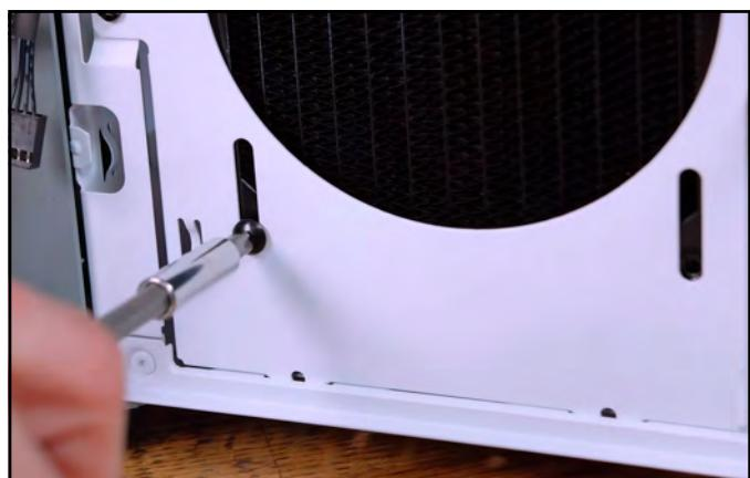
**B:** Bruges ved montering af 25mm tykke standardblæsere på køleren, enten direkte eller via et kabinet.
