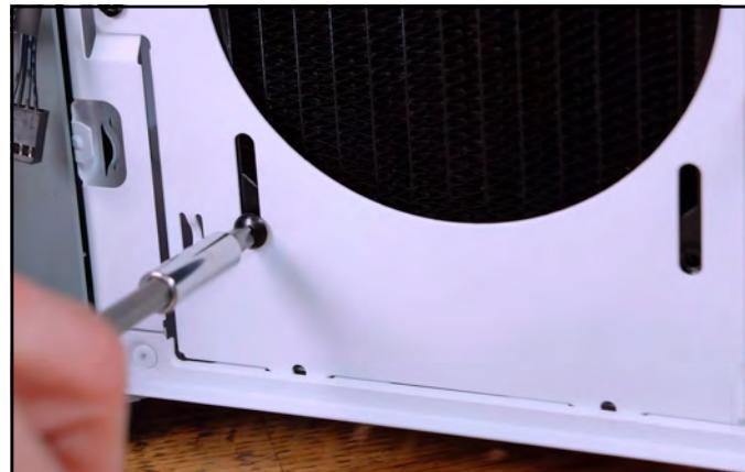
**B:** Da utilizzare per montare le ventole standard di 25mm di spessore al radiatore, direttamente o con il telaio.
